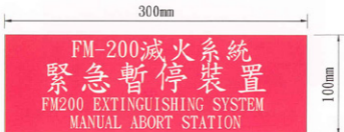
緊急暫停裝置標示牌
